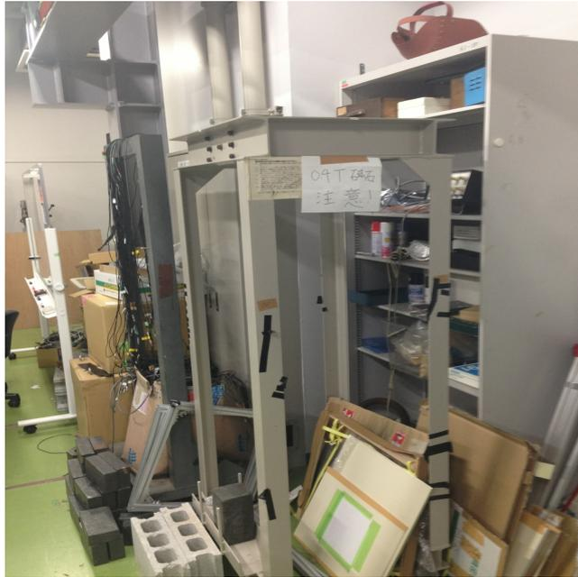
図 5.3: 実験に使用した磁石を設置してあるラック：中央部に四角に穴が開いており向かい合う形で磁石 (0.4T) が固定されてある
