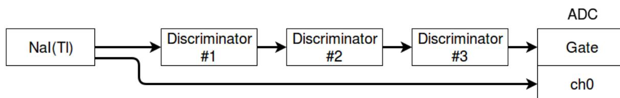
図 4.5: ADC の較正
