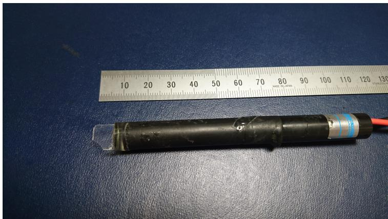
図 3.3: プラスチックシンチレーション検出器
