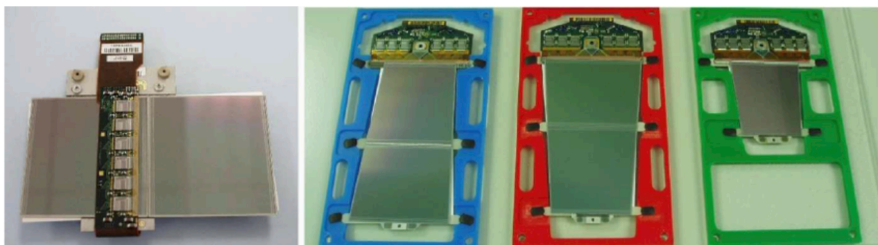
図 2.6 SCT のバレルモジュール (左図) とエンドキャップモジュール (右図)。エンドキャップは左から Outer, Middle, Inner の順 [15]。
