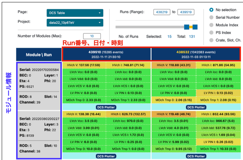
図2.16 DCS Table のディスプレイ。モジュールの運転状況に関するパラメータを、各 Run、各モジュールごとに表示する。これにより、ユーザーは各モジュールの運転状況や各 Run ごとの傾向を見ることができる。
