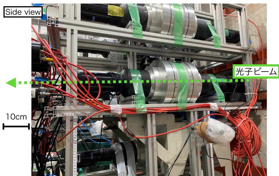
図 4.8 8 台の液体シンチレータを設置した様子。
