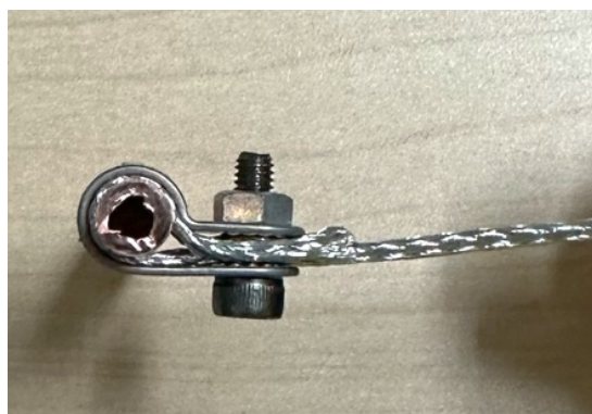
図 2.26 水冷銅管と銅網線の接続部分を上から見た図。UCV 実機ではよりコンパクトなボルト、ナットとより短いネジを用いる予定である。
