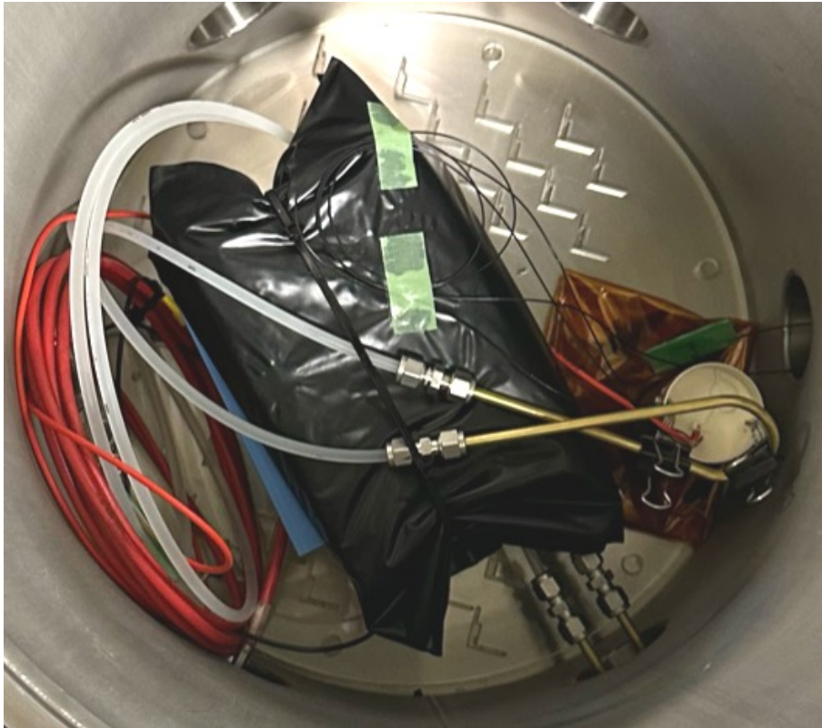
図 3.2 真空チェンバー内の放熱試験のセットアップを上から見た写真。PMT を冷やす部分の配管のみ真鍮で、それ以外の配管は樹脂からなる。真鍮管と樹脂配管は、真空用のチューブ継手で接合されている。PMT のみを冷やすために、真鍮管と継手はプラスチックの空箱の上に置き、床と熱的に絶縁している。写真ではプラスチック箱はブラックシートに覆われている。
