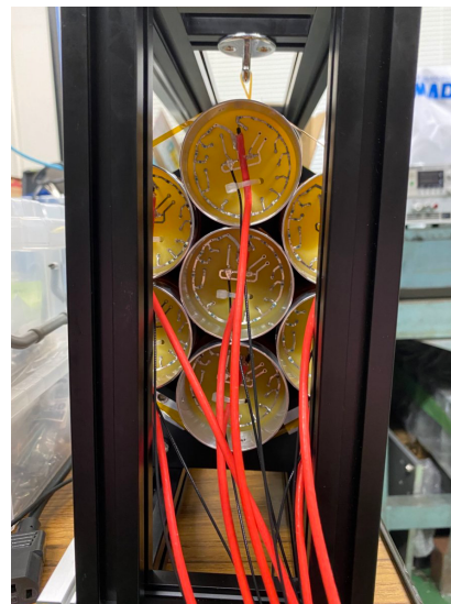
図 1.9 X 軸方向から見た UCV の写真。PMT は紙面奥側にある PMT ホルダーに挿入され、固定されている。
