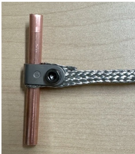
図 2.25 水冷銅管と銅網線の接続部分を横から見た図。
