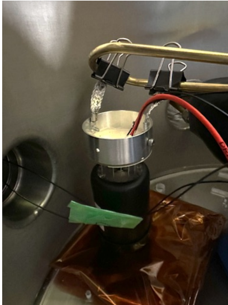
図 3.3 真空チェンバー内の放熱試験のセットアップを、PMT の近くから見た写真。 この写真においては、2本の銅網線が Al 筒に接続されている。
