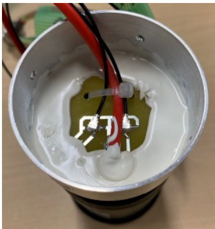
図 2.19 PMT、アルミニウム筒と接合された基板の、抵抗側の写真。同軸コネクタ部を除いてシリコンがポッティングされている。UCV に使用する際は全面にポッティングを施す。
