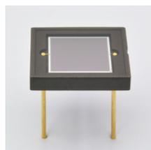
図 1.10 結晶上流面に取り付ける MPPC (S13360-6050CS) [9]。
