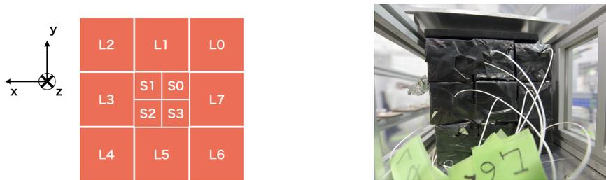
図 2.2 (左) 前面から見た CsI 結晶の配置。(右) その写真。結晶側面はアルミナイズドマイラーで覆われており、前面からは MPPC の信号を読み出すためのケーブルが出ている。
