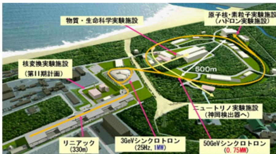
図 1.2: J-PARC の全体図 [6]。KOTO 実験はこの施設のハドロン実験施設で行っている実験である。
