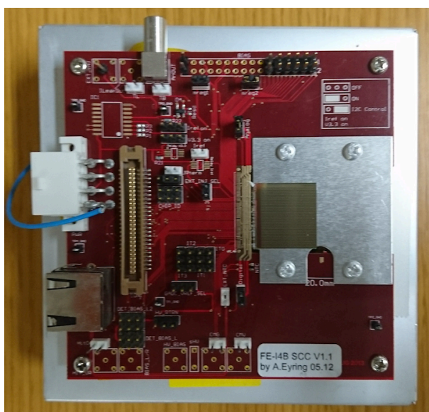
Fig. 2.1: FE-I4 が実装された基板の写真。中央右の銀色の正方形のアルミカバーの上に置かれたチップが FE-I4 である。
