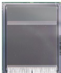
図 2.1: SVX テレスコープに用いるシリコンストリップセンサ。写真はすでに本体基板に実装された状態である。上部の色が違う領域には、poly-Si を用いてバイアス抵抗が実装されている。下部には、読み出し ASIC へ繋がるワイヤが見える。
