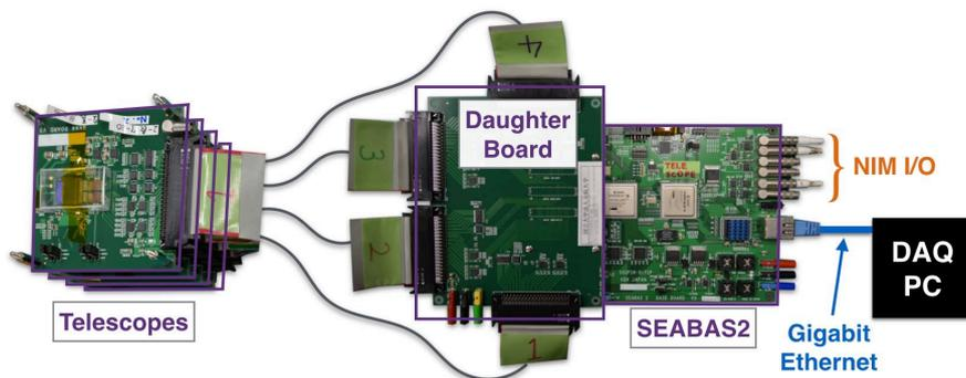
図 2.8: 本体基板と SEABAS2 が接続された状態の SVX テレスコープ。
