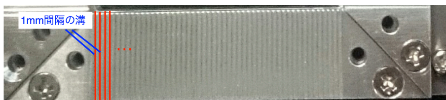
図 2.14: ファイバーを固定する 1mm 間隔の溝付きアルミニウム板 (土台側)
