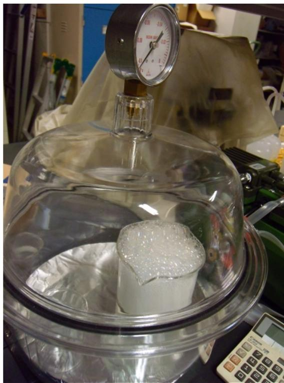
図 3.1: シリコンの液を混合し攪拌したのち、デシケーターに入れて脱泡をしている様子。
