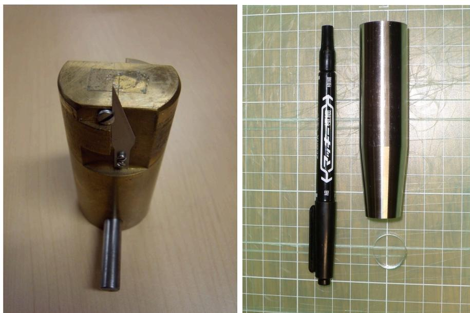
図 3.6: 50mm 角の結晶用のクッキーのカッター (左) と 25mm 角の結晶用のクッキーのカッター (右)。50mm 角の結晶用のクッキーのカッターは、KTeV 実験でクッキーの切りとりに製作されたもの。刃 (Aven Tools 44205S) だけを取りかえて使用している。この円柱がちょうど入る穴をもつアクリル板をカッターの回転のガイドとして用いる。
