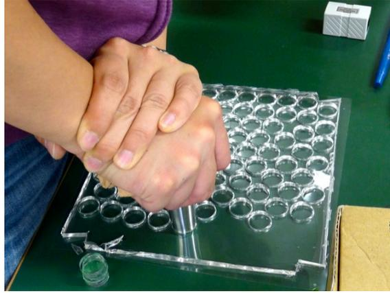
図 3.7: 25mm 角の結晶用のクッキーを切抜く様子。
