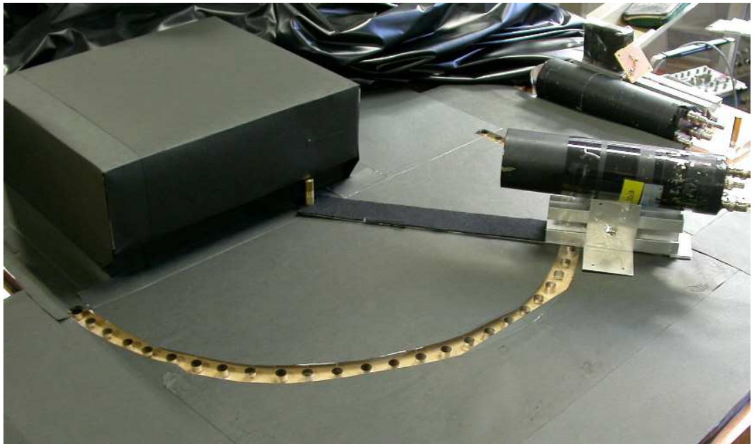
図 2.3: 実験のセットアップ (左の暗箱中に LED と fiber が入っており、測定端のみ外に出ている。右は測定用 PMT)
