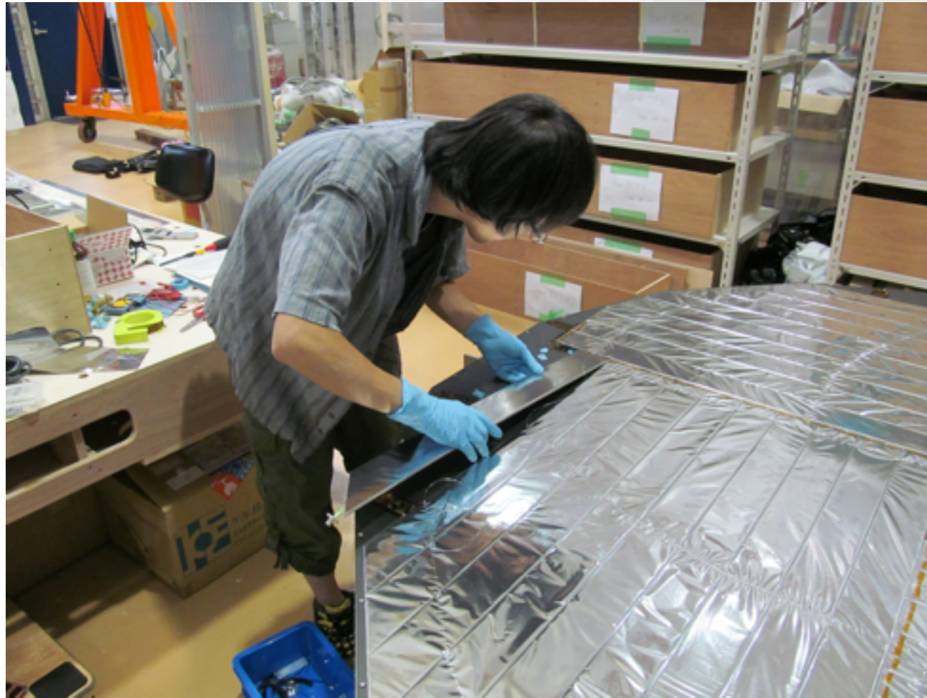
シンチレータをCFRPの上に置く
