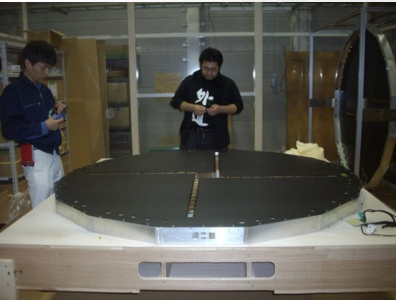
アルミフレームにCFRPを張りつけ
