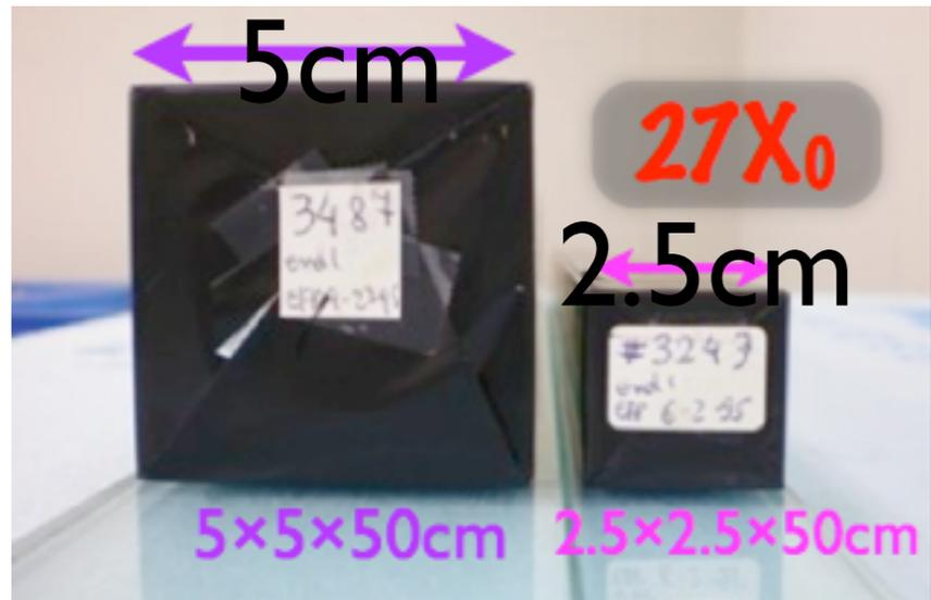
1. FNALのKTeV実験で使われたCsIカロリメータを解体・輸送・テスト・建設された(4年x4+人)。
