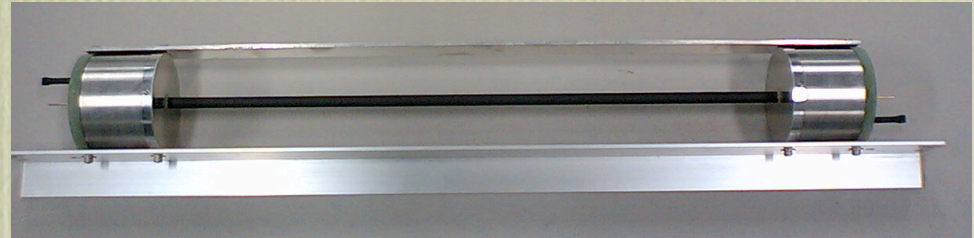
3.3 M \Omega / \square の抵抗を持つPEEKストローチューブ
